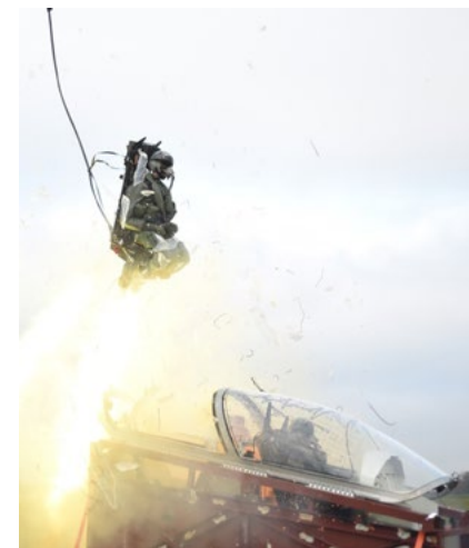
Pozemní zkouška záchranného systému
